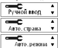
При выборе параметра «**Ручной ввод**» с помощью кнопок или можно установить таймаут ручного ввода (1, 5, 10 или 20 мин). Для сохранения установленного значения нажмите . После этого следует автоматический возврат в меню «Параметры». Вернуться к выбору параметров без изменения значения нажмите кнопку.
