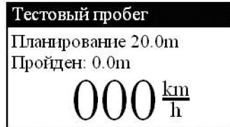
ну, в нем отображается запланированное расстояние, пройденное и текущая скорость. При достижении одинаковых значений расстояния в строках «Планирование» и «Пройден» нужно остановить ТС и нажать клавишу «OK»
