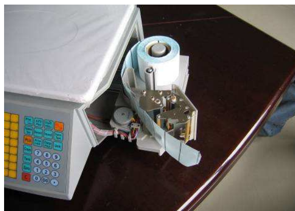
5. Установить рулон с этикетками, предварительно сняв несколько этикеток с начала рулона.
