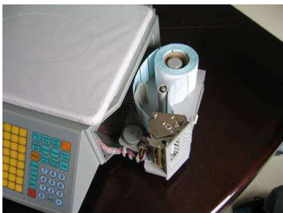
8. Заправить конец рулона в намотчик и повернуть намотчик до натяжения ленты.
