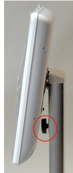
10. Отрегулировать угол наклона дисплея
