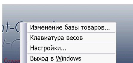
Для входа в настройки весов, выбрать пункт «Настройки». Пункт «Клавиатура весов» служит для просмотра информации с дисплея весов и эмуляции нажатий кнопок на весах. Пункт «Выход в Windows» закрывает программу.
